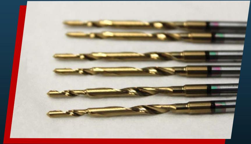
Spezialbohrer mit leitfähigen und isolierenden Hartschichten aus Titannitrid ( $\text{TiN}$ ) und Siliziumnitrid ( $\text{Si}_3\text{N}_4$ ).
